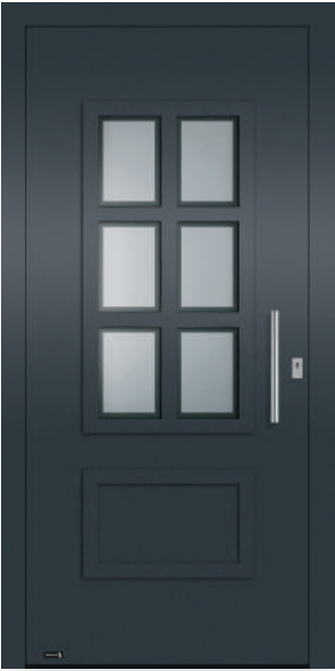
5126 Hier flügelüberdeckend mit Stoßgriff 5722.350 dargestellt. Ornamentrahmen unten innen und außen. V: VSG mattiert mit klarem Rand; Lichtes Glasmaß: 534 mm x 1056 mm O: ca. RAL 7016 Nightgrey FS U p : 1,2
