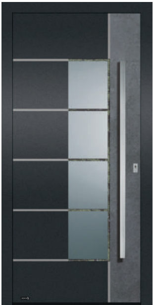
5004 Hier flügelüberdeckend mit nicht flächenbündigen Lisenen in NIRO-Design und Stoßgriff 5803.1400 dargestellt. V: VSG mattiert mit klaren Streifen; Lichtes Glasmaß: 290 mm x 1450 mm O: Grundfarbe Dark FSM A: Keramik Dark Slate U g : 1,1
