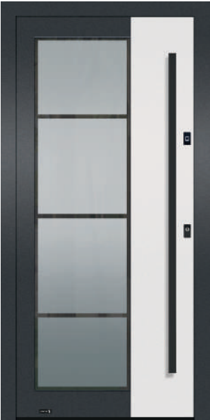
5508 Hier teilflügelüberdeckend mit Stoßgriff 5825.1600 und Fingerprint ekey dLine im Türblatt montiert dargestellt. V: VSG mattiert mit klarem Rand und Streifen O: White Aluminium FSM A: ca. DB 703 A: ca. RAL 9016 Snow FS U g : 1,3 RC2 und RC3 optional
