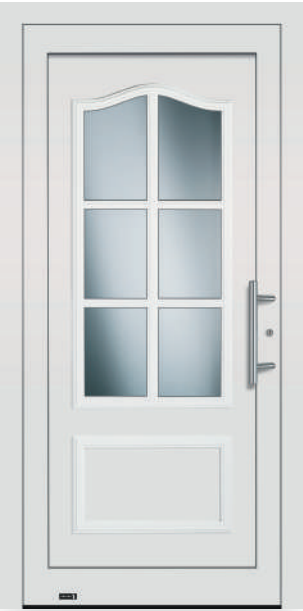
5101 Hier als Glasfalz-Füllung und mit Stoßgriff 5722.350 dargestellt. Ornamentrahmen unten innen und außen. V: VSG beschichtet; Lichtes Glasmaß: 534 mm x 1110 mm H: Float, Chi. Weiß oder Mastercarre weiß O: ca. RAL 9016 Verkehrsweiß U p : 1,1
