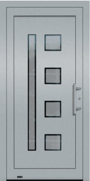
5409 Hier als Glasfalz-Fllung und mit Stogriff 5722.350 dargestellt. V: VSG mattiert mit klarem Rand; Lichtes Glasma: 400 mm x 1400 mm O: White Aluminium FSM U D : 1,1
