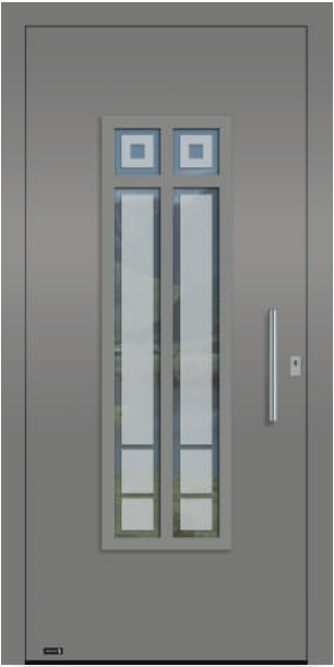
5123 Hier flügelüberdeckend mit Stoßgriff 5722.350 dargestellt. V: VSG mattiert mit klarem Rand, Streifen und Quadraten; Lichtes Glasmaß: 296 mm x 1296 mm O: ca. RAL 9007 Graualuminium matt U p : 1,2
